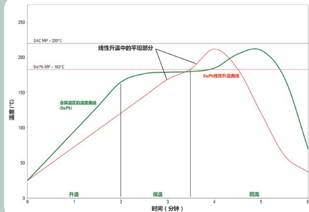
表中推荐的曲线适用于Sn63和Sn62含铅合金。使用NC-SMQ92J时，上表可作为确定回流曲线的一般性参考。根据特定的工艺要求(包括基板大小、厚度和密度)，对曲线做出改动是可行的，也可能是必要的。可以先从线性曲线开始，然后移到非必须的保温区间。如必要，线性曲线中的水平保温区间(线性波峰)也可以被移除。
