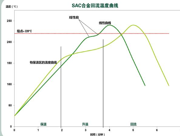
表中推荐的曲线适用于大多数SnAgCu（SAC）的无铅合金，包括SAC305（96.5%锡/3%银/0.5%铜）。使用Indium10.1HF时，上表可作为确定回流曲线的一般性参考。根据特定的工艺要求（包括基板大小、厚度和密度），对曲线做出改动是可行的，也可能是必要的。线性曲线中的水平保溫区间（线性波峰）也可以被移除。
