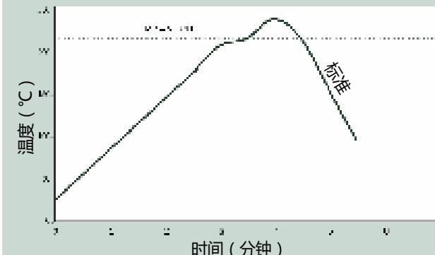
Indium3.2HF应在空气或者氮气中使用线性曲线进行回流。表中推荐的曲线可为采用了SnAgCu、SnAg和SnSb合金系统的Indium3.2HF设计回流曲线提供参考。
