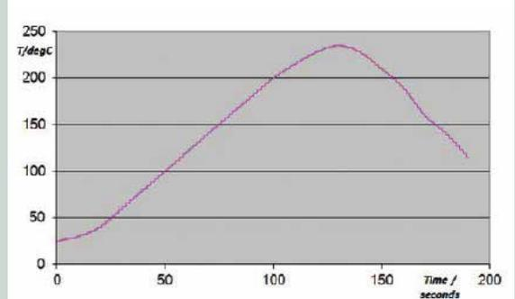
倒装芯片助焊剂NC-26S应使用氧气含量低于100ppm的氮气气氛进行回流。尽管取得最佳结果仍需惰性气氛，某些应用可采用空气气氛。倒装芯片助焊剂NC-26S可在多种表面上使用，包括浸银、铜和AuNi。这些表面可用SnPb或者无铅合金进行焊接，然而当温度超过240°C以后需要使用氮气气氛。
