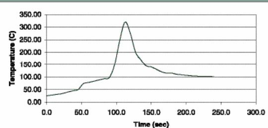
表中推荐的典型曲线适用于高铅合金(铅含量不低于80%)在混合气氛或氮气气氛(氧气含量小于100ppm)下回流的情况。上表可作为确定回流曲线的一般性参考。根据特定的工艺要求(包括基板大小、厚度和密度)，对曲线做出改动是可行的，也可能是必要的。采用液相线温度不同的合金也要求对曲线进行调整。
